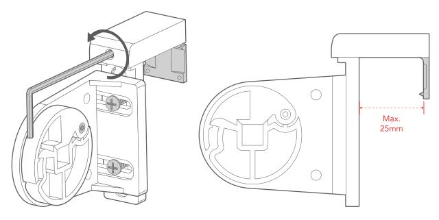
Utilizzate la chiave a brugola in dotazione per aprire la staffa. La staffa si apre fino a un massimo di 25 mm.
