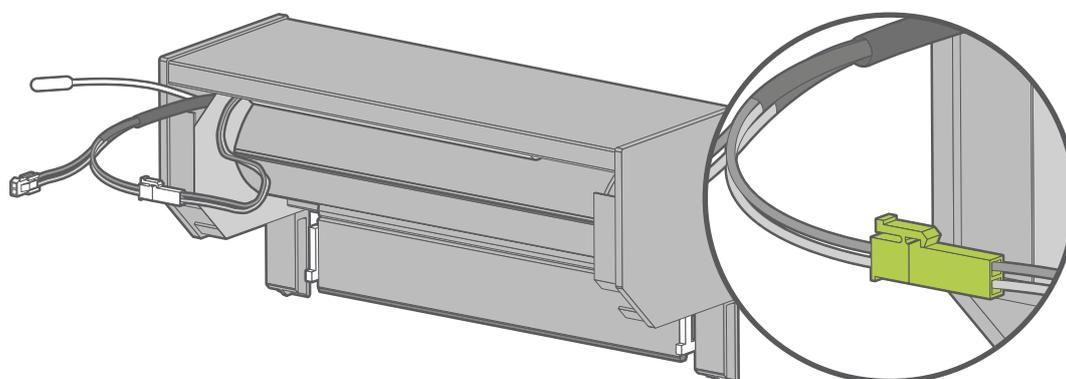
Adesso connettete il cavo della batteria al cavo del motore.
