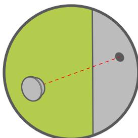
In caso di installazione frontale delle guide, utilizzate i tappi coprivite in dotazione. Questi sono progettati per adattarsi ad un foro di 12 mm di diametro, quindi se nella fase 1 avete usato una punta più piccola di 12 mm, allargate i fori arrivando al diametro corretto.
