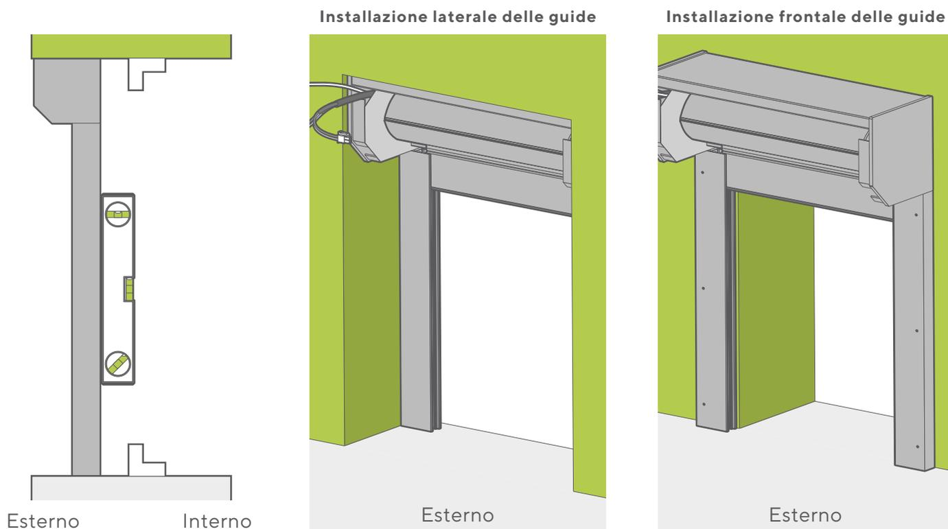
Posizionate la tapparella assemblata nella posizione in cui la monterete. Utilizzate una livella a bolla d'aria per assicurarvi che sia dritto e in piano.
