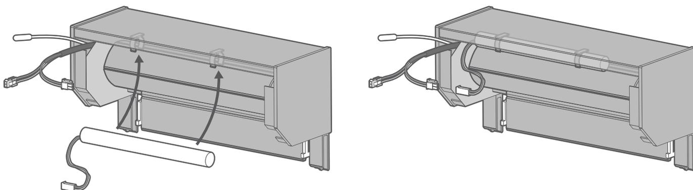
Spingete la batteria verso l'alto, verso le clip montate all'interno del cassetto, tenendo poi il cavo della batteria vicino al cavo del motore.
