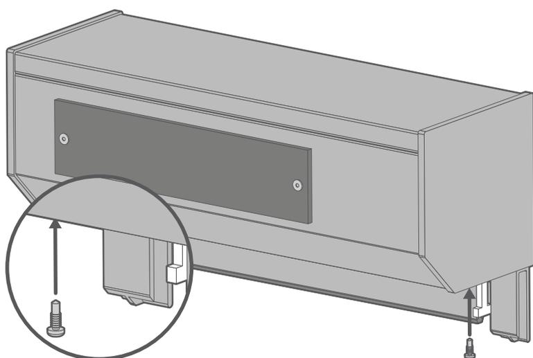
Inserite con cura tutti i cavi all'interno del cassetto, quindi avvitate il coperchio in posizione.
