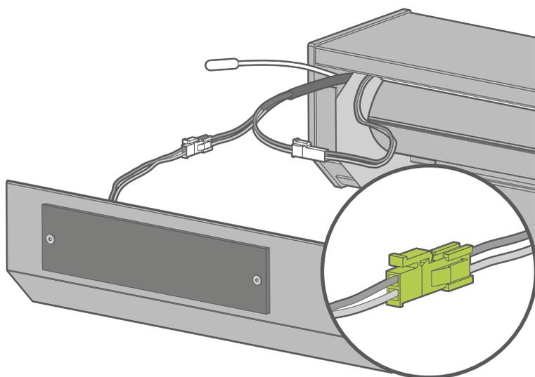
Collegate il cavo del pannello solare (sul retro del coperchio del cassetto rimosso al punto 2) al cavo del motore.
