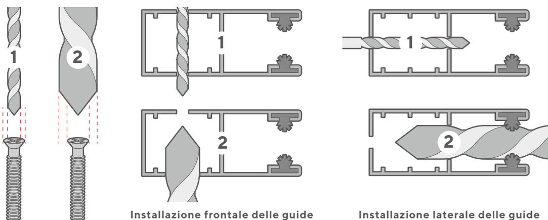
Con una punta di diametro inferiore alla testa della vite, forate il telaio passando da parte a parte (1). Successivamente con una punta più larga della testa della vite (vi consigliamo di usare una punta da 12 mm), forate solo un lato del telaio (2), in questo modo sarà possibile far scorrere la vite sul fondo del telaio quando lo si avviterà in posizione.
