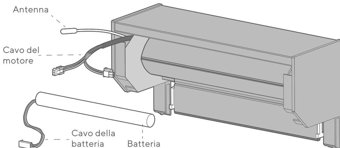
La batteria deve essere montata all'interno del cassetto e i cavi della batteria e del motore devono essere collegati tra loro.
