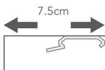
Se state utilizzando staffe a soffitto, assicuratevi di montarle ad almeno 7,5 cm di distanza dal telaio della finestra, o da qualsiasi elemento sporgente, se presente. In questo modo garantirete lo spazio necessario perché le tende si muovano senza intralci.
