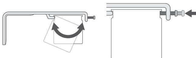
Posizionate il bordo posteriore del finecorsa nel gancio posteriore della staffa. Sollevate la parte anteriore del finecorsa in modo che sia livellato, quindi stringete la vite come in figura.
