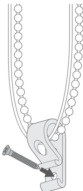
Le nostre tende verticali sono pienamente conformi ai più recenti standard di sicurezza. Sono fornite di un dispositivo di tensionamento 'P-Clip' per mantenere le corde e la catena in sicurezza.
