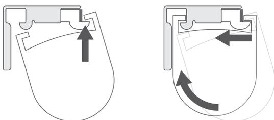
Appoggiate il finecorsa nella parte anteriore della staffa. Successivamente ruotate il finecorsa verso l'alto fino a quando non si aggancerà alla parte posteriore della staffa.
