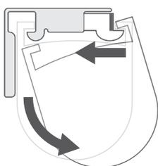
Per sganciare la tenda dalle staffe dopo l'installazione, spingete con forza contro il finecorsa della tenda per sganciarlo dalla parte anteriore della staffa. Contemporaneamente, ruotate il retro verso il basso per sganciarlo dalla parte posteriore.
