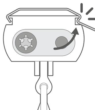
Quindi ruotate la linguetta posteriore del binario verso l'alto fino a quando non si aggancia saldamente al gancio posteriore della staffa.
