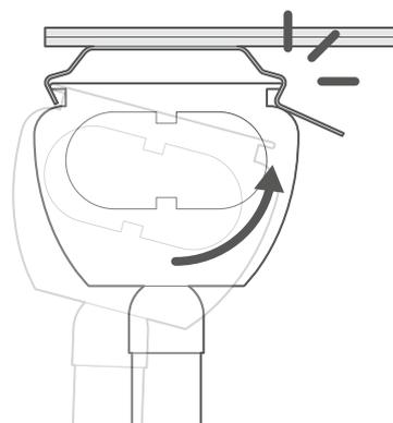
Quindi ruotate la linguetta posteriore del binario verso l'alto fino a quando non si aggancia saldamente al gancio posteriore della staffa.
