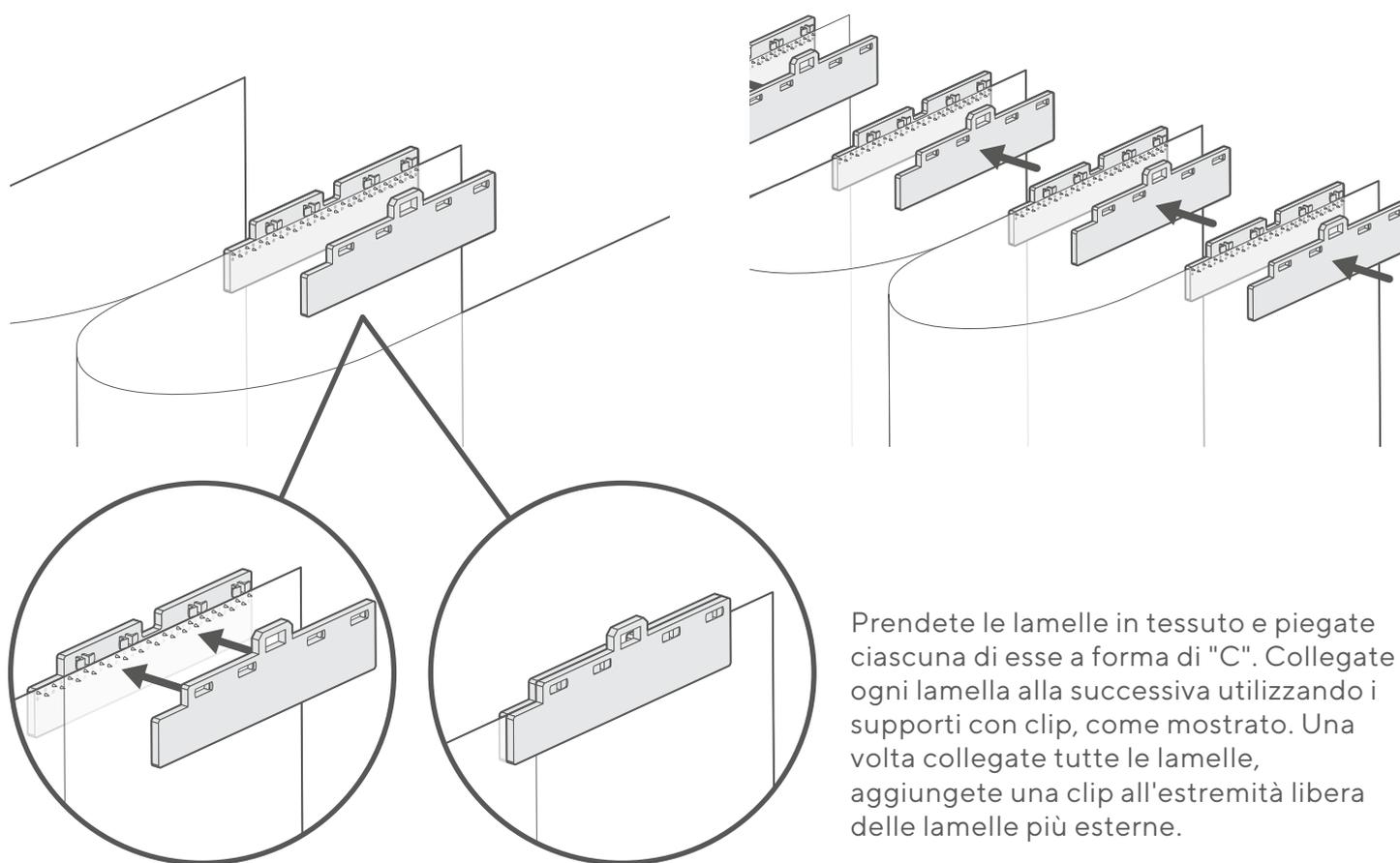
Prendete le lamelle in tessuto e piegate ciascuna di esse a forma di "C". Collegate ogni lamella alla successiva utilizzando i supporti con clip, come mostrato. Una volta collegate tutte le lamelle, aggiungete una clip all'estremità libera delle lamelle più esterne.
